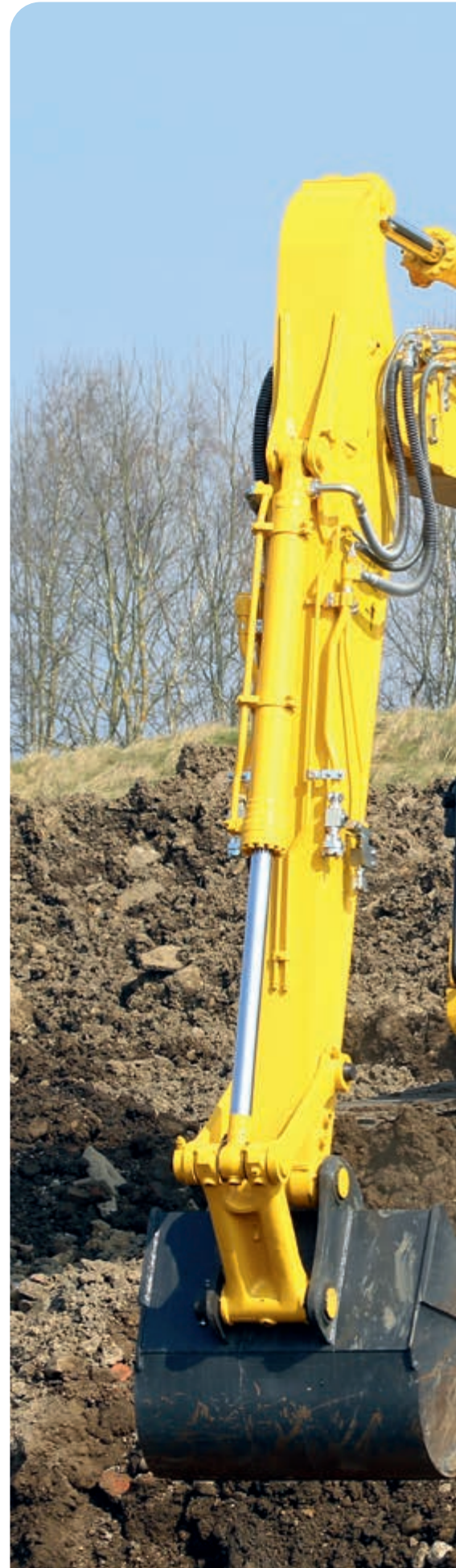
Дві опціональні гідравлічні лінії для кріплення різноманітного навісного обладнання
