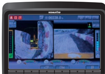
Система KomVision надає доступ до різноманітних параметрів виду з камери, що забезпечують постійний огляд згори машини
